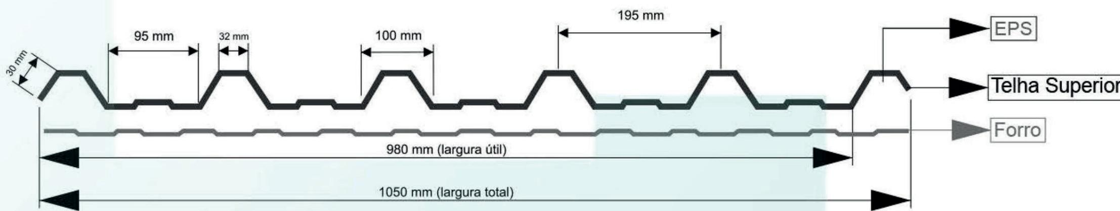
As telhas modelos TP 25, 35 e 40 são recomendadas para aplicação em coberturas em que se exigem resistência a sobrecargas concentradas. Também podem ser utilizadas em coberturas e fechamentos laterais de ambientes, aos quais se deseja atribuir grande isolamento.
